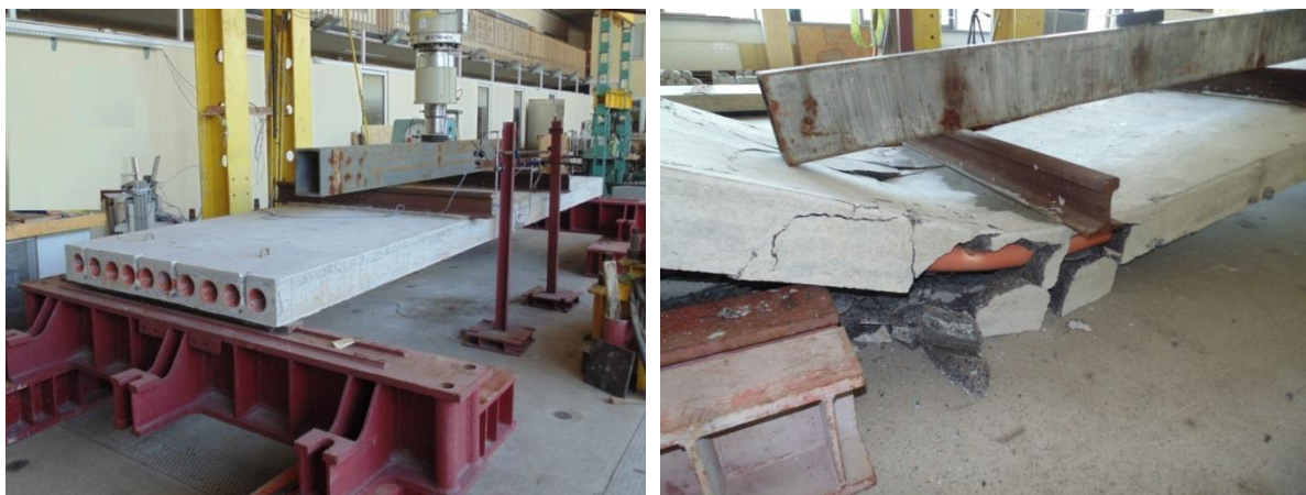
Rys. 10 Widok płyty na stanowisku badawczym przed obciążeniem i po zniszczeniu.
