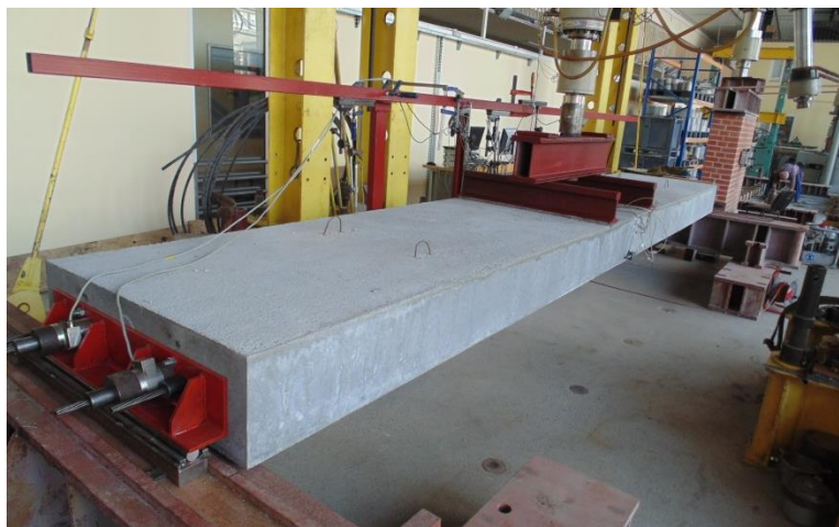
Rys. 3 Widok płyty wagi 60-tonowej na stanowisku badawczym.
