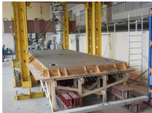
Rys. 6 Widok prototypu płyty wagi 30 tonowej przed i po zabetonowaniu.
