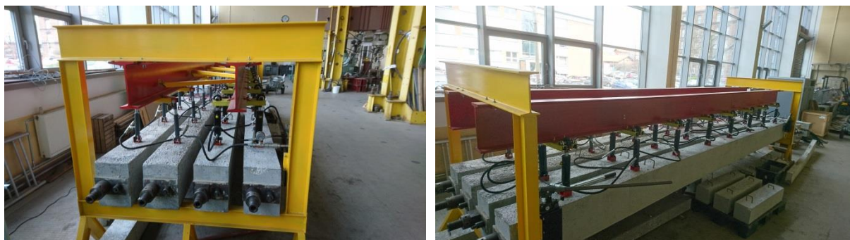
Rys. 25 Zaprojektowane stanowisko badawcze do długotrwałego obciążenia belek kablobetonowych.
