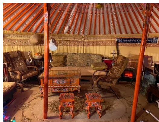
Fot. 2. Wnętrze jurty wraz z dwoma słupami wspierającymi konstrukcję dachu.
