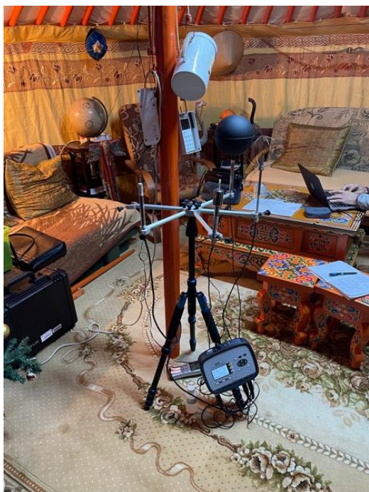
Fot. 3. Wnętrze jurty, na pierwszym planie przyrząd do pomiarów komfortu cieplnego
