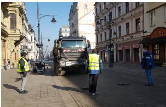
Wymuszenie pojazdem ciężarowym drgań budynku przy ul. Piotrkowskiej.
