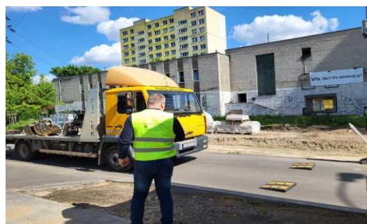
Pomiary drgań na ul. Struga 90 w Teatrze „Szwalnia” – wymuszenia drgań samochodem ciężarowym.
